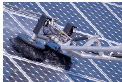
**Zwei gegenläufige Bürsten mit reichlich Wasser und darüber befindet sich eine Wasserdüsen-Einheit – damit werden Photovoltaik-Module wieder „sonnenklar“.**
